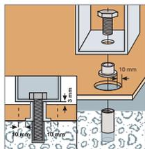
Nei casi in cui si debba fissare al pavimento elementi di arredo o funzionali, consente di evitare il bloccaggio delle dilatazioni del pavimento e conseguenti sollevamenti dello stesso.
